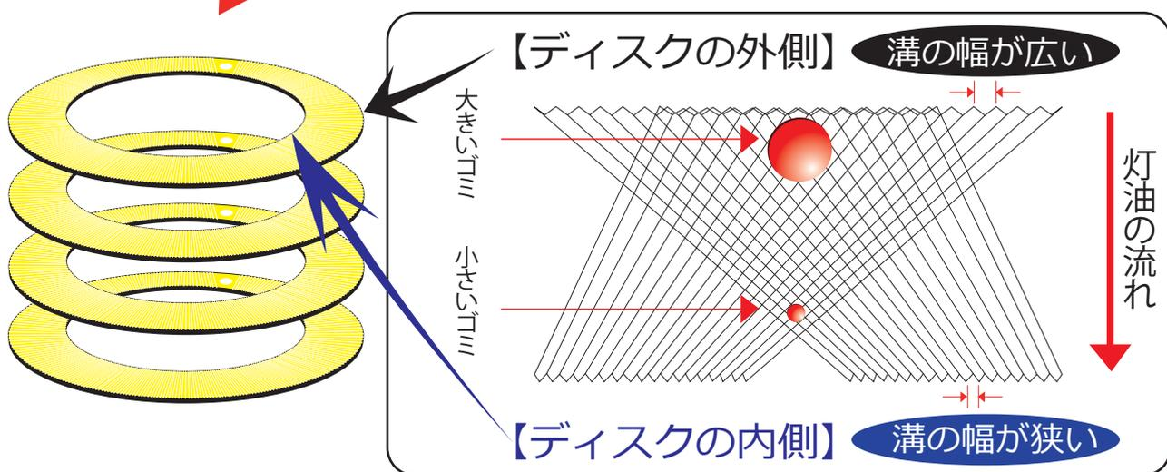
汚れをミクロン単位で取り除くディスク式フィルターを140枚装着しています。
